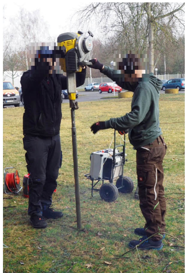
Abb. 2: Testmessung der THM im Gelände. Hier zu sehen ist der Bohrvorgang für die anschließende Radonbodenluftmessung. Im Hintergrund ist das Rotameter zu sehen, welches den Volumenstrom des Radongases misst.
