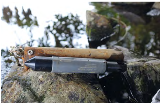
Abb. 4: Datenlogger und Schutzhülle in Edertal-Mehlen
