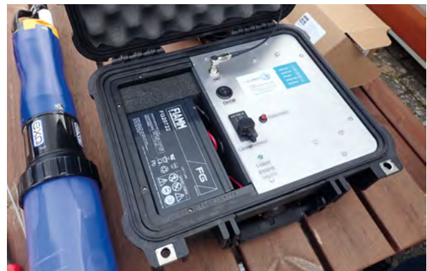
Abb. 5: Multiparametersonde mit Datenfernübertragung im Ablauf der Affolderner Talsperre
