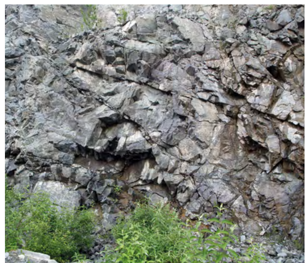
Abb. 5 Kluftsysteme verschiedener Steinbrüche, A: Engständiges und ebenmäßiges Kluftsystem mit Wasseraustritt, B: Chaotisch erscheinendes Kluftsystem (Bildbreite 4 m)
