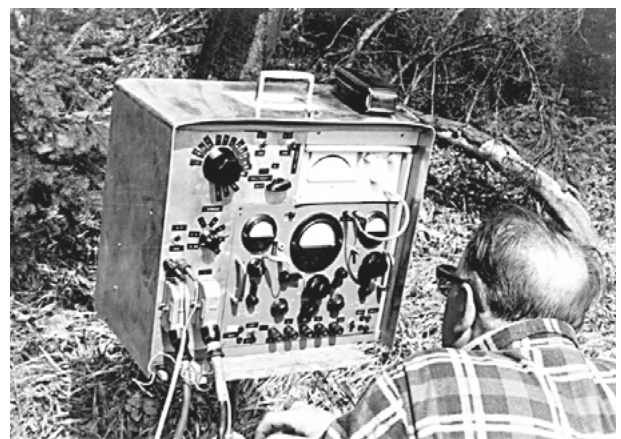
Abb. 1 Einsatz einer älteren Geoelektrik im Gelände
