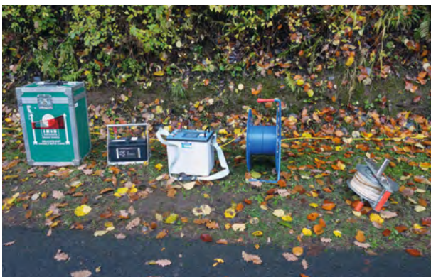
Abb. 2 Komponenten der geoelektrischen Tomografieapparatur: links: Stromversorgung, Messapparatur und Kabel, rechts: Beispiel für eine Messauslage
