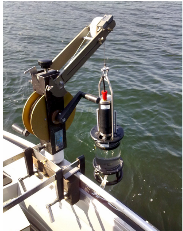
Abb. 4: Planktonprobenahme mit einem tiefenintegrierenden Wasserschöpfer.
