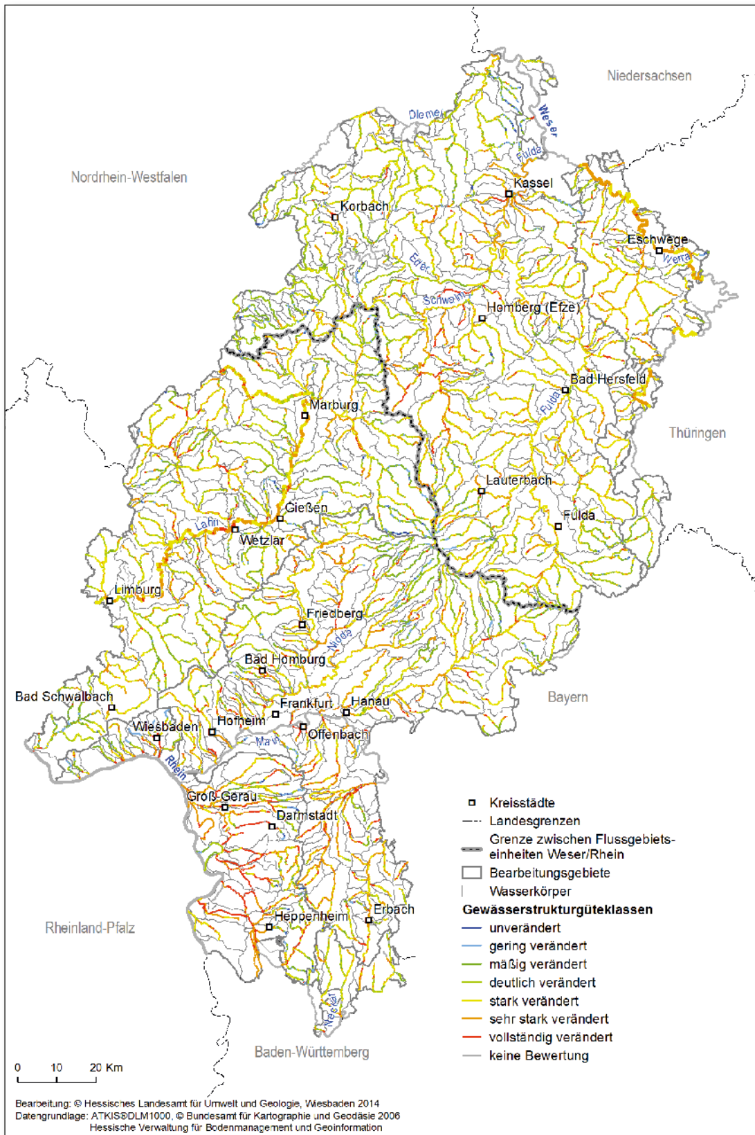
Abb. 3: Ergebnis der neuen Gewässerstrukturkartierung (Gesamtbewertung). (Datengrundlage: Kartierung 2012/2013, HLU 2014).
