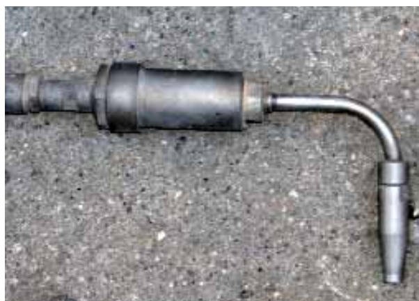
Abb. 4: Falsch montierte Staubsonde.
