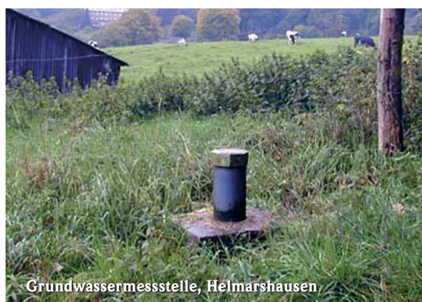
Abb. 1: Beispiele für Grundwasseraufschlüsse, an denen Quellschüttung und Wasserstände gemessen werden.
