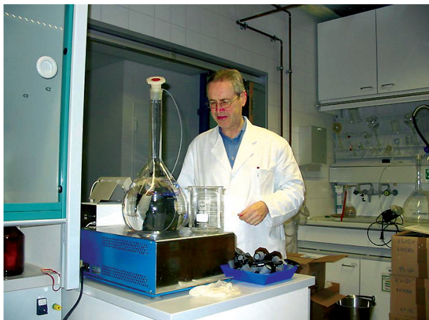
Abb. 2: Herstellung von RV-Proben durch Direktdotierung in die Probenflasche.
