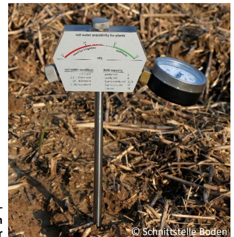
Kontrolle der Bodenfeuchte mit einem Tensiometer
