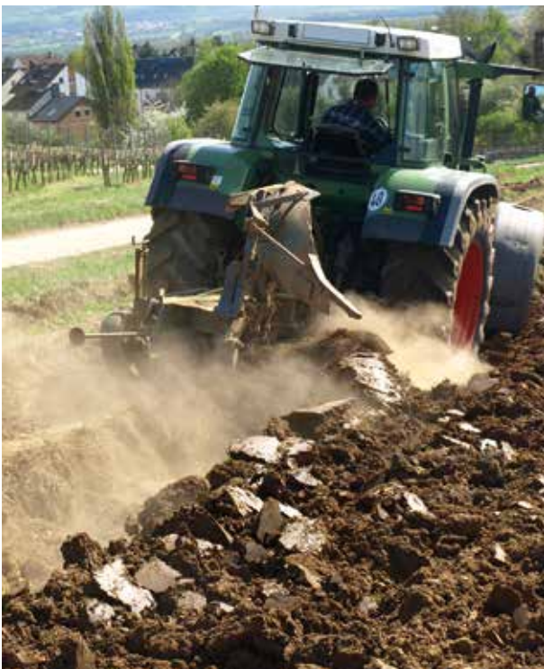
Abb. 18: Rigolpflug im Einsatz.
