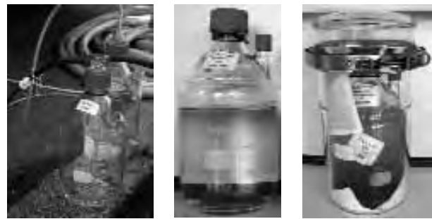
Abb. 2: Beispiel für Mikrokosmen in 2L-Glasflaschen, links: Befüllung mit Grundwasser im Feld, Mitte: Batchflasche im Labor, rechts: anaerobe Inkubation in einem Anaerobtopf.
