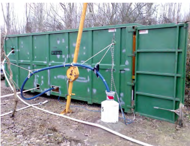
Abb. 7+8: Container mit mobiler Pumpenanlage zur Grundwasser-Beprobung.
