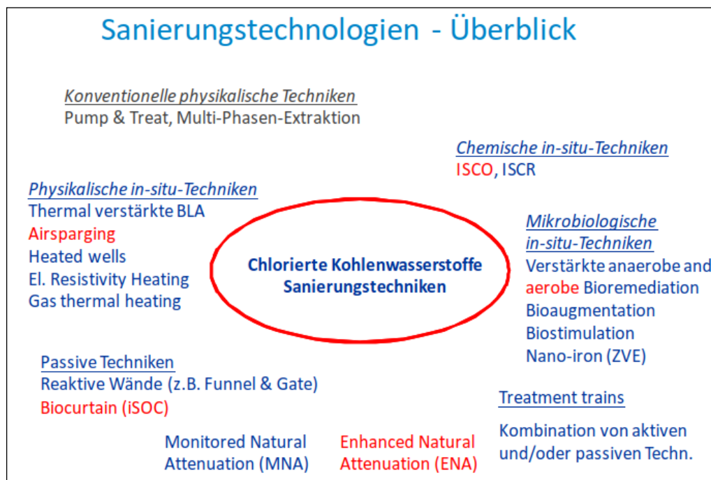
Abb. 1: LHKW-Sanierungstechnologien im Grundwasser im Überblick
