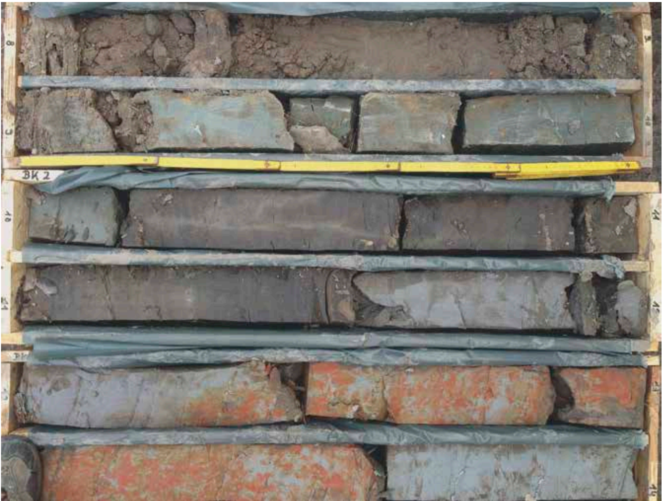
Abb. 7: Ausschnitt aus einer Kernbohrung, die typische pliozäne braungraue Feinsande (8–9 m) und grüne, dunkelbraune, hellgraue Tone mit rötlicher Marmorierung zeigt (Quelle: Mainzer Landstr. 395, BK 2, 8–14 m)
