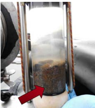
Abb. 4: Beprobung von Main-Sediment mittels Sedi-Corer (Fa. Uwi-tec) © BCE Koblenz
