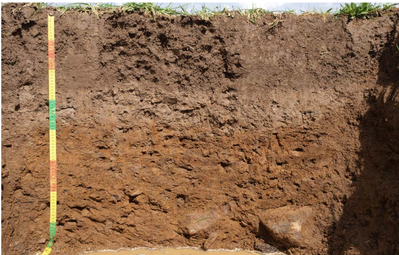
Abb. 4: Pseudogley über Basaltverwitterung (Feldatal-Windhausen), der helle Bereich zeigt eine Bleichung durch Stauwasser an © HLNUG
