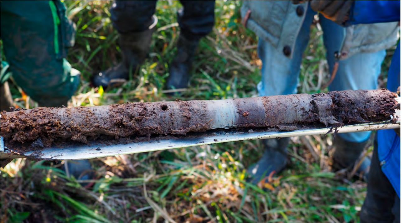
Abb. 4: Profilbohrung mit der Moorklappsonde, beispielhaft für das Untersuchungsgebiet Oberrospehe. Die kartierten Moorböden waren meist gekennzeichnet von einem Wechsel aus organischen Torfen (dunkle Farbe) und mineralischen Auensubstraten (hellgraue Farbe). © HLNUG
