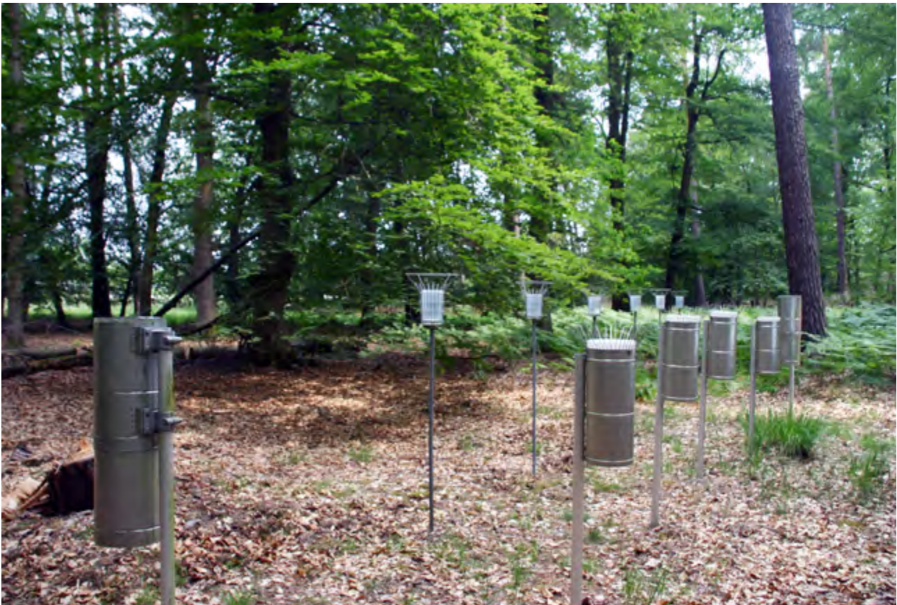
Abb. 3: Blick auf die hessische Intensiv-Messstelle Frankfurt Flughafen mit Depositionssammlern © HLNUG
