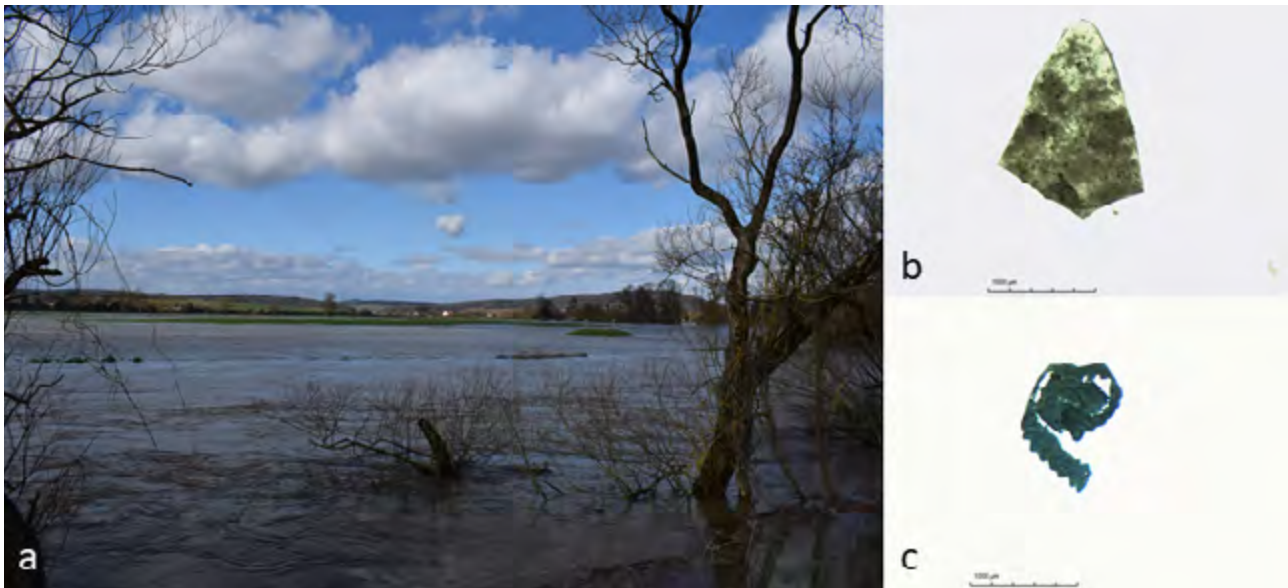
Abb. 1: Überflutete Lahnaue und Mikroplastikpartikel. a: Lahnaue bei Roth während des Frühjahrhochwassers 2020, b: Polyethylen Bruchstück mit anhaftendem Feinboden, c: Polystyrol Partikel © Collin Weber
