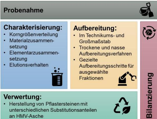
Abb. 2: Vorgehensweise zur Identifikation der optimalsten Aufbereitungs- und Verwertungsrouten
