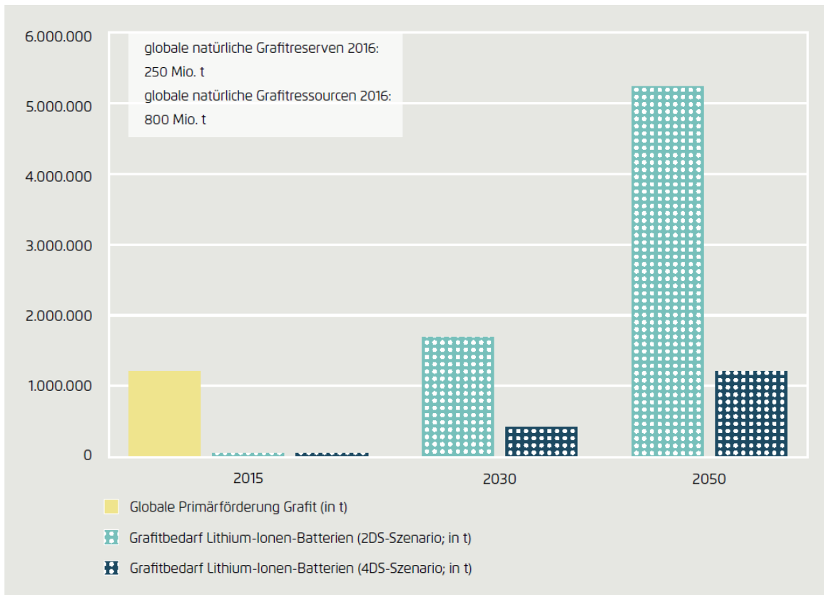
Abbildung 24: Globaler Graphitbedarf in Lithium-Ionen-Batterien für Fahrzeuge 2015, 2030, 2050 in den Szenarien 2DS und 4DS und Sekundärmaterialpotenziale (in Tonnen) (Buchert, Degreif, & Dolega, 2017, S. 31)
