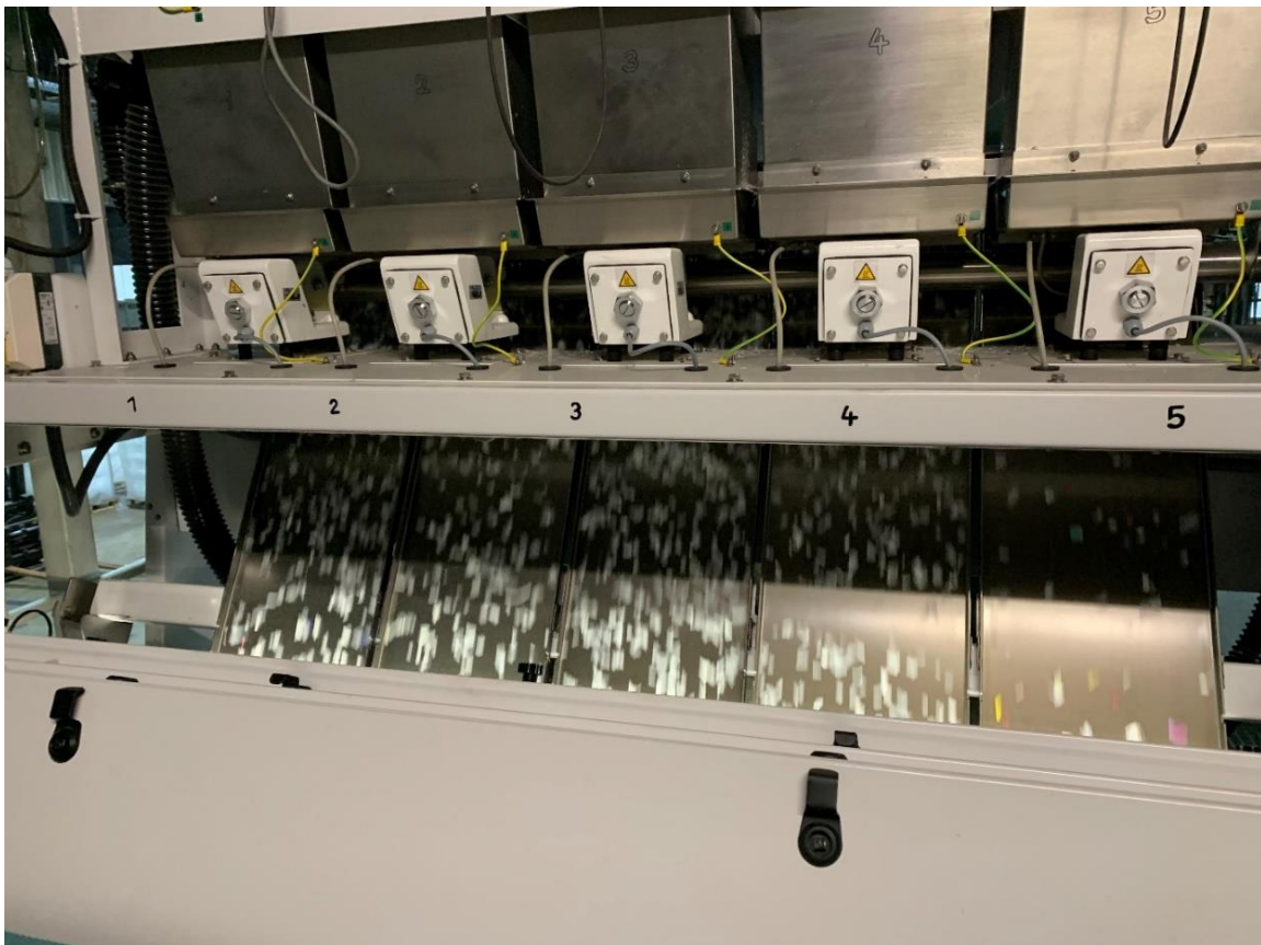
Abbildung 9: Farbsortierung von PE-HD Flakes über fünf Rutschen (© Turuc, A.)
