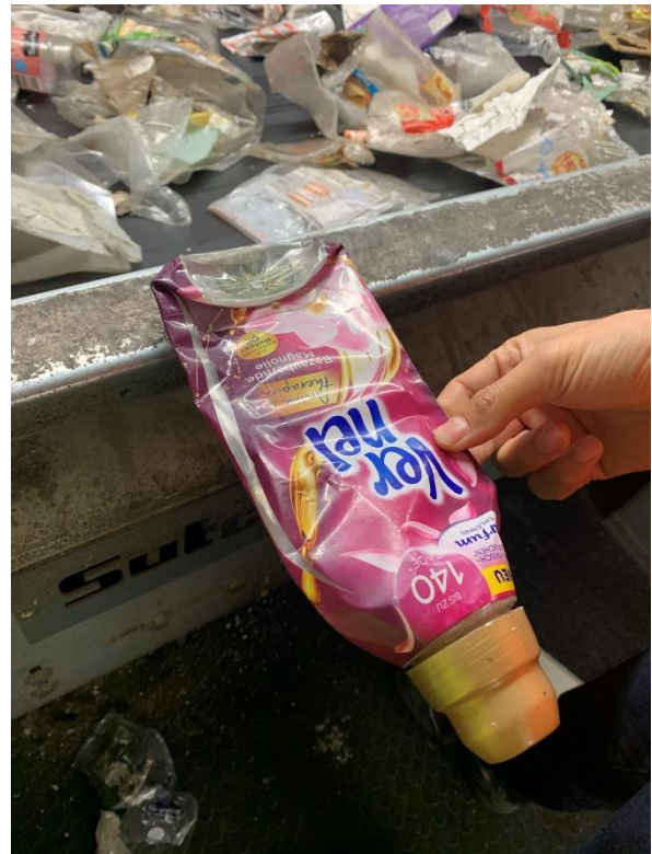
Abbildung 18: Verschattung durch Kunststoffbänderolen. Links: Produktumhüllende Kunststoffbänderole mit schwarzer Innenfärbung. Rechts: Fast vollständige Oberflächenverschattung durch die Banderole.
