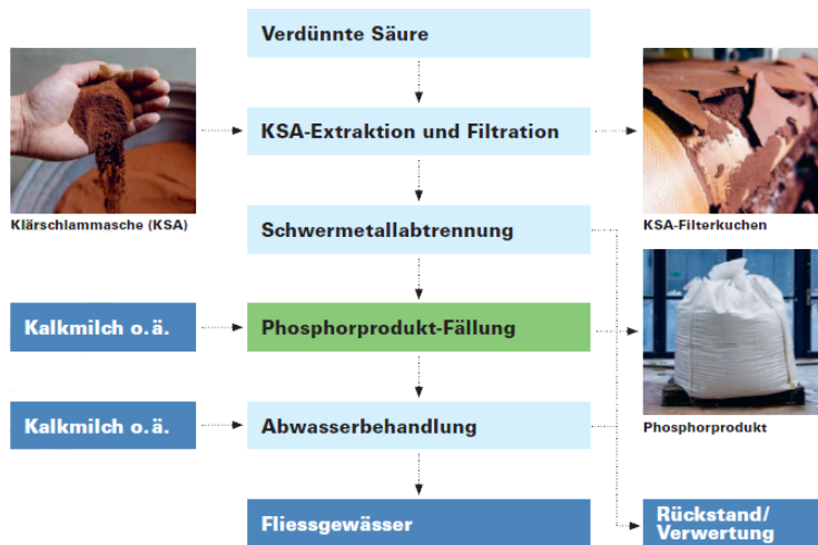
Abbildung 30 - Schematische Darstellung des LEACHPHOS® Verfahrens (Amt für Abfall, Wasser, Energie und Luft des Kantons Zürich, 2013)
